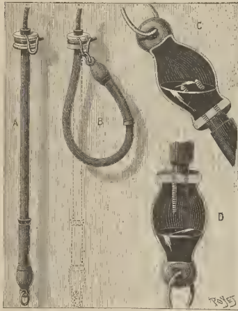
Interruptor de mercurio. - A y D Posiciones de interrupción. B y C. Posiciones de cerradura
